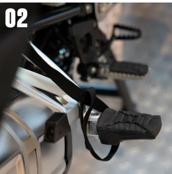
**D****Befestigung LIVIGNO Art. 4542****Riemensystem mit Klemmschnalle (Spanngurte und Zurrschlaufen).**
